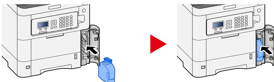
**6 Закройте крышку отработанного тонера**
