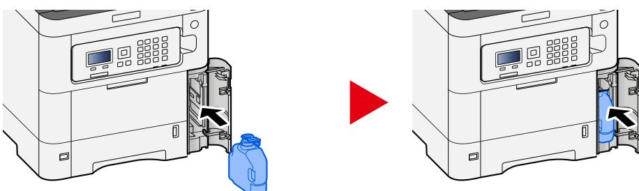
**6 Закройте крышку отработанного тонера**
